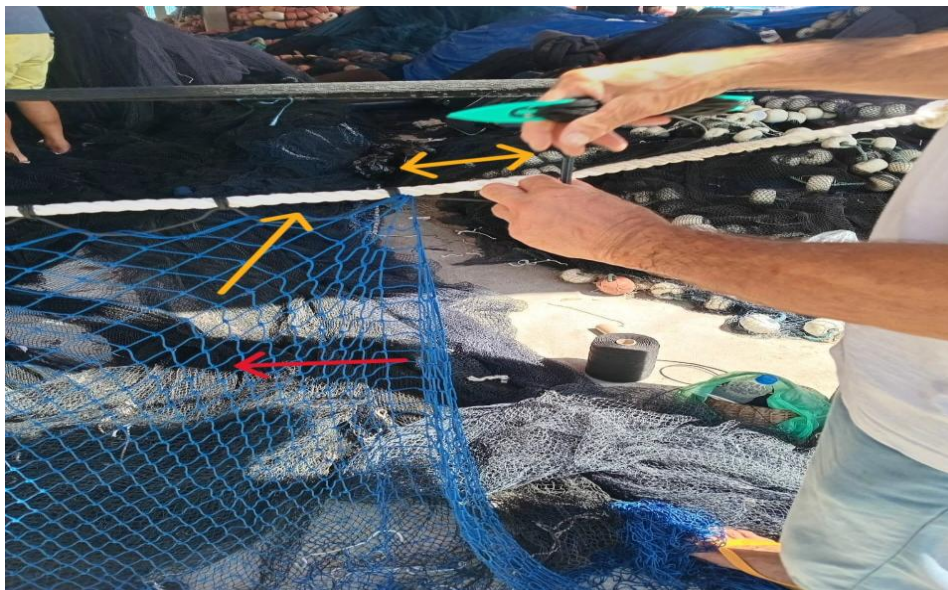
Figura 26. Redeiro entralhando a rede. Nesta imagem percebem-se pelas setas amarela as bitolas. A seta vermelha aponta o calço do chumbo. Fonte: O autor
