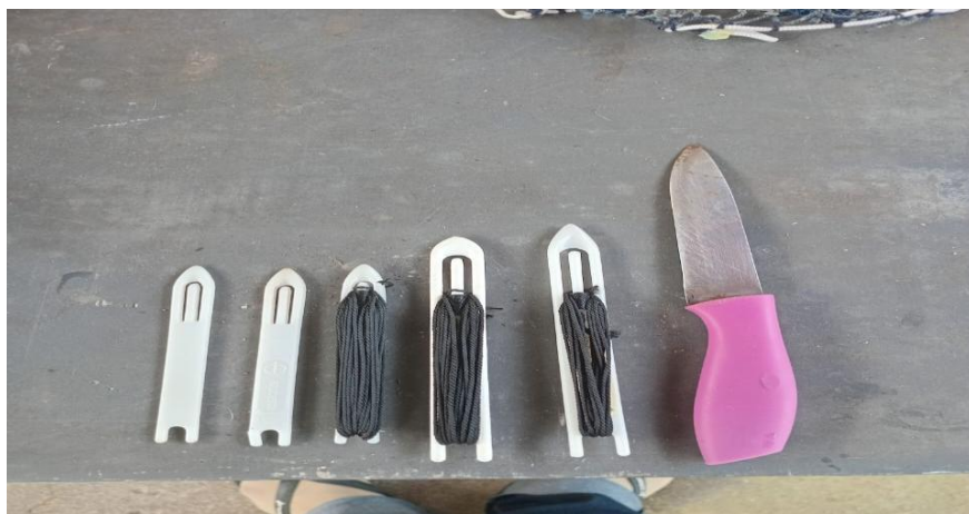
Figura 23. Tamanhos diferentes de agulhas de remendo. As menores para remendo linha 16 mm, as maiores para perfilhos linha 22 mm, faca para corte das malhas.
