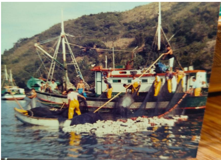
Figura 10. Barco de traineira dos anos 80 sem Power block . rede colida de forma braçal. Fonte: o autor.
