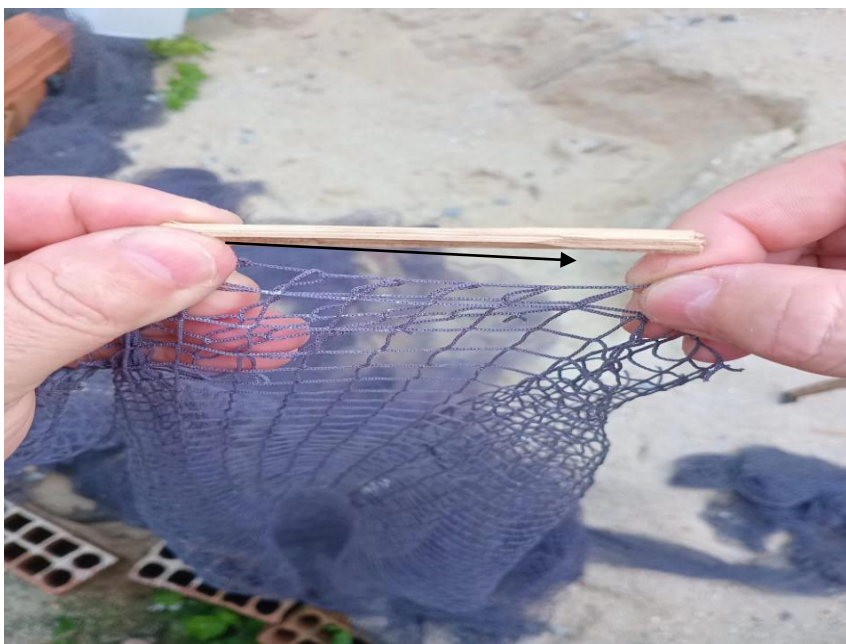
Figura 31. Forma tradicional de medição de bitola de uma traineira. Fonte: O autor
